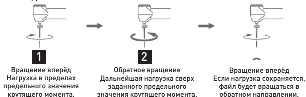
Рисунок 7: Защитная функция автоматического реверса
